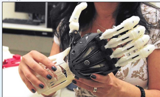
Prótese infantil feita de plástico pela Unifesp: material mais preciso, leve, econômico e ajustável
