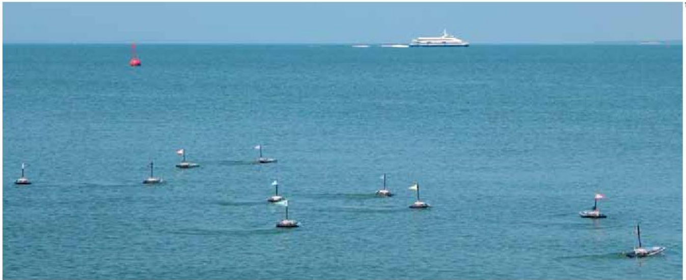
Experimento com grupo de robôs-barcos no rio Tejo, em Portugal, testa sistemas para ações coletivas como localização, agrupamento e dispersão
