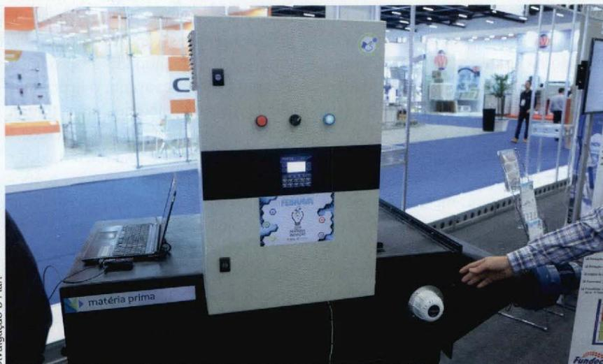
Sistema de refrigeração para controle das condições de armazenagem de grãos
