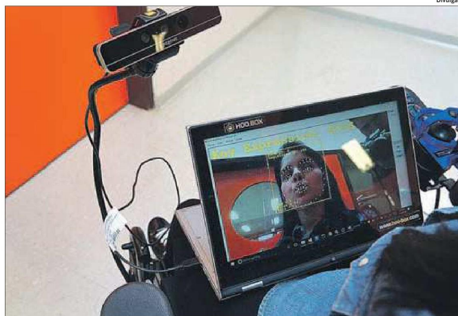
Empresa HooBox desenvolve kit que permite mover cadeira elétrica por meio de movimentos faciais
