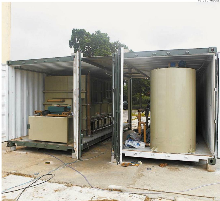
A estrutura, montada em dois contêineres e que ficará no José Menino, tem 36 m² e pode ser transportada
