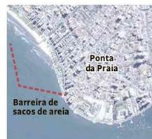
A instalação de uma **barreira submersa** com sacos de areia, chamados também de geobags, tem como objetivo frear a força das ondas antes que elas atinjam a costa
