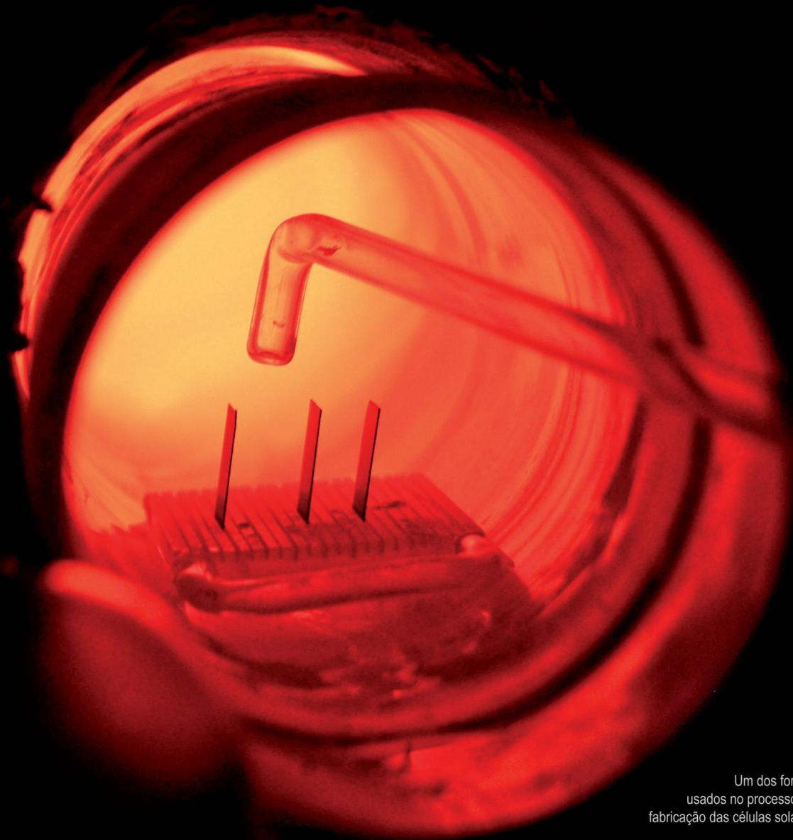
Um dos fornos usados no processo de fabricação das células solares
