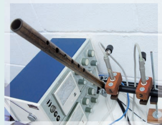
Pífono em laboratório: construção e validação de um medidor de impedância para sistemas tubulares
