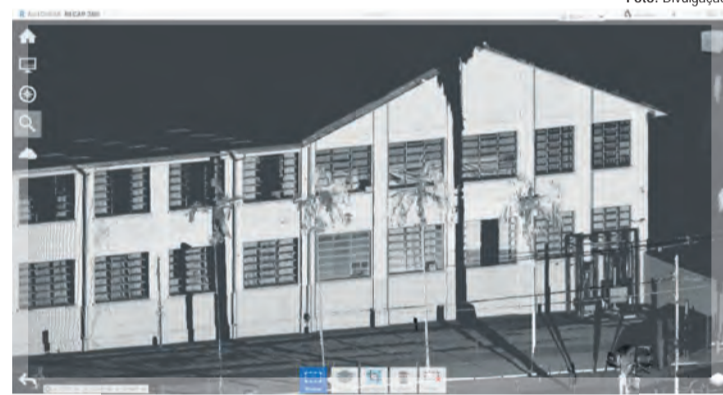
Imagem de trecho da nuvem de pontos levantada com escaneamento a laser da fachada do Edifício Prada, em Limeira
