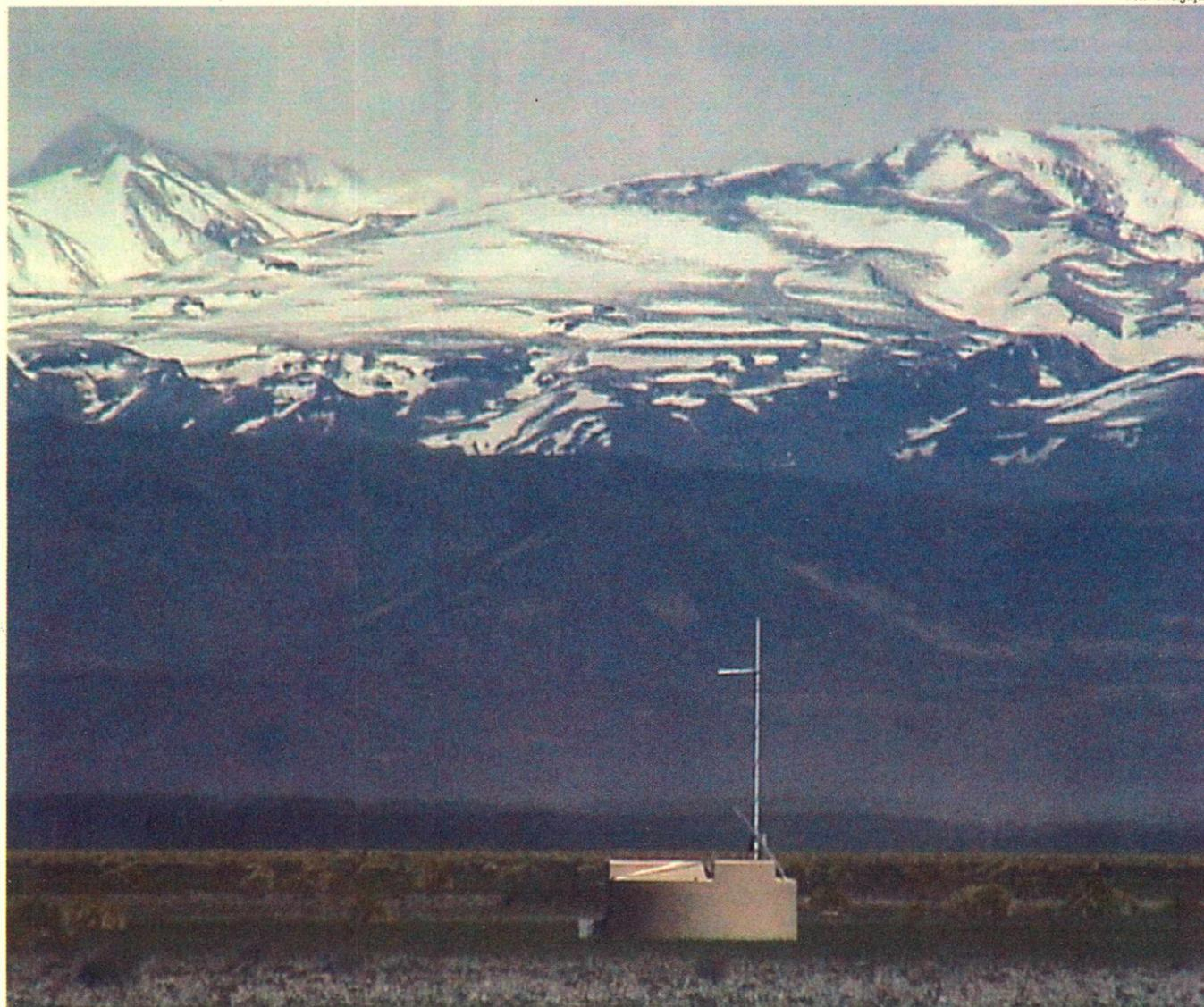
Tanque detector de partículas de alta energia instalado no Observatório Pierre Auger, na Argentina: projeto envolve 250 cientistas de dez países
