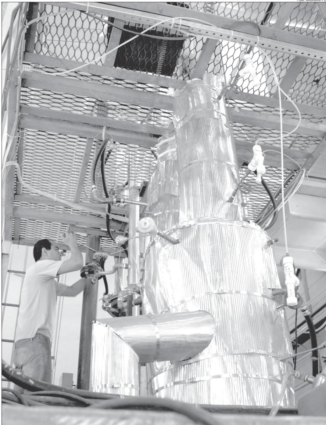
Reator em laboratório da FEM: único equipamento de leito fluidizado circulante em escala piloto em funcionamento em universidades brasileiras
